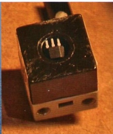
Zelf gemaakte Hall-effect sensor Dit is een "schakelaar" die een magnetisch veld kan detecteren. Zie ook artikel in clubblad 2007-1.
