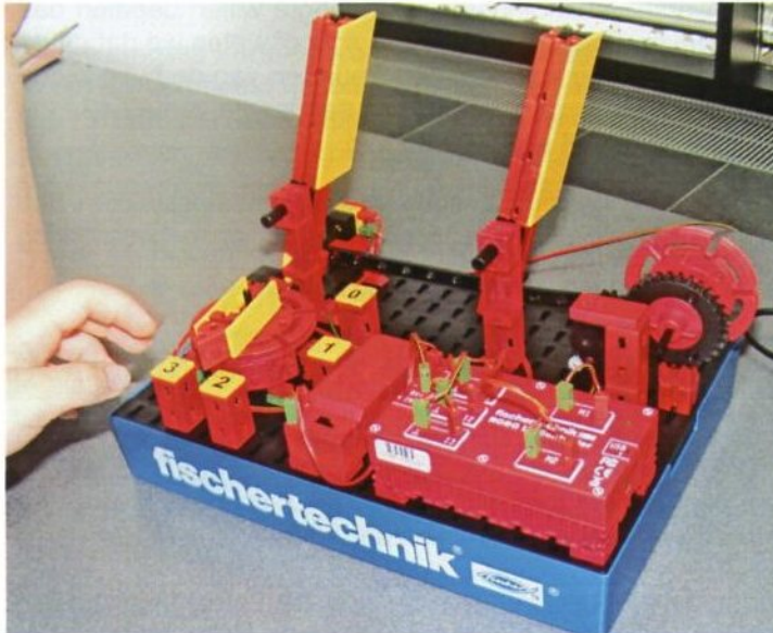
Ruitenwissers gemaakt met de ROBO LT interface.
