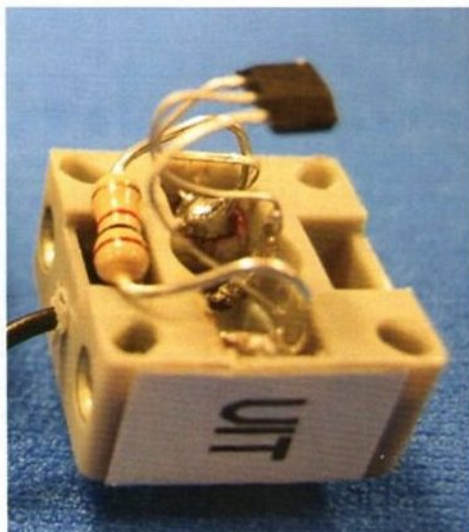
Zelf gemaakte Hall-effect sensor Dit is een "schakelaar" die een magnetisch veld kan detecteren. Zie ook artikel in clubblad 2007-1.
